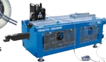
GRUNDOBURST - Système d'éclatement statique, Types 400G, 400S (regard), 800G, 1250G et 2500G renouvellement de tubes jusqu'au Ø 1000 mm
