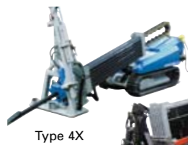
GRUNDOBURST - Système d'éclatement statique, Types 400G, 400S (regard), 800G, 1250G et 2500G renouvellement de tubes jusqu'au Ø 1000 mm
