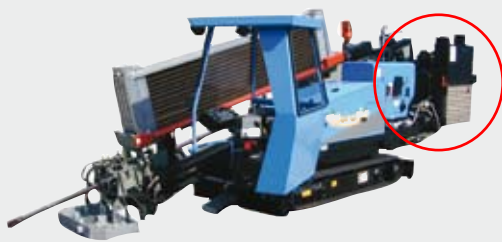
Série X avec une force de traction et de poussée de 7,10,13 et 15 t Unique: Grundodril 7 X avec centrale de malaxage
