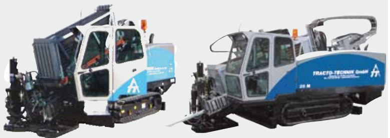
Série N avec cabine de pilotage (force de traction et de poussée de 15 et 25 tonnes)
